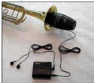
Figura 6. Sordina per tromba (Fonte: Linee guida europee [1]).
